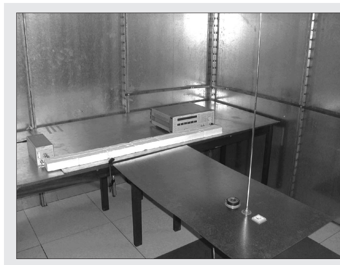
Abb. 1: Messaufbau im Schirmraum ohne allseitig leitfähige Verbindung zur Wand des Schirmraumes
